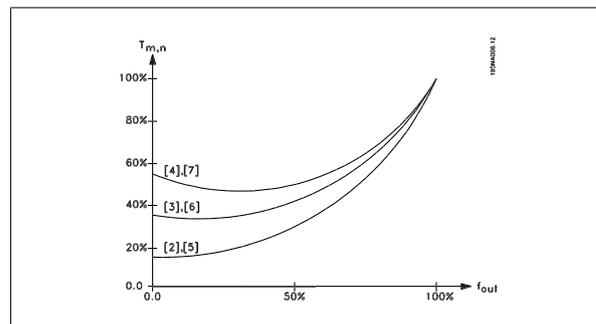
Selecione *Modo especial do motor* [8] se for necessário ajuste U/f especial que deve ser adaptado ao motor atual. Os pontos de interrupção são programados nos parâmetros 423-428 *Tensão/frequência*.
