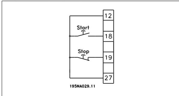
*Partida por pulso*, se um pulso for aplicado durante 14 ms no mínimo, o conversor de frequência dará partida no motor desde que não tenha sido aplicado um comando de parada. O motor pode ser parado ao se ativar brevemente *Parada inversa*.
