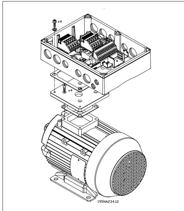
1. Prepare a placa de adaptação para montagem do motor perfurando os furos de fixação e os furos dos cabos.
