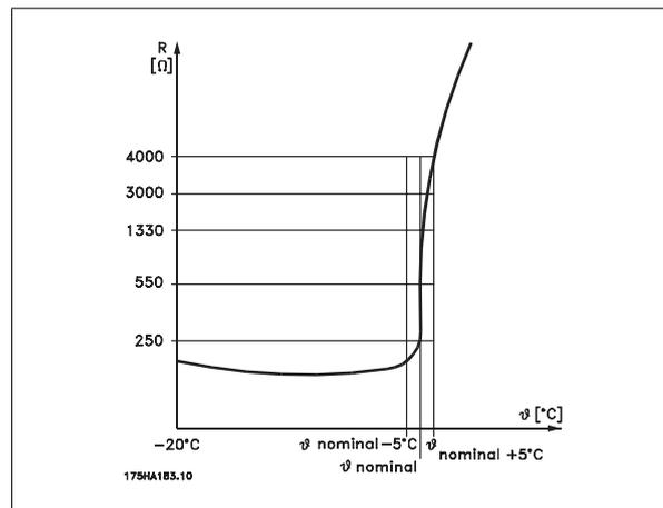
Por outro lado, se um motor usar um interruptor térmico Klixon, ele também poderá ser conectado à entrada. Se os motores operarem em paralelo, os termistores/interruptores térmicos podem ser conectados em série (resistência total inferior a 3 kΩ).
