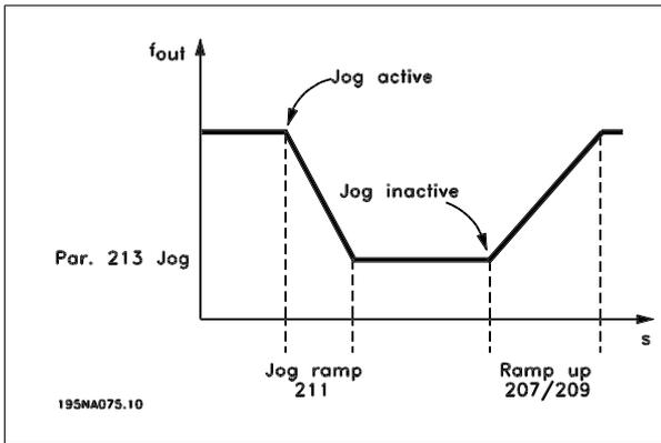
O tempo de rampa para o jog inicia se um sinal de jog for dado através do painel de controle local, de uma das entradas digitais ou via porta de comunicação serial.
