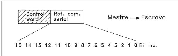
A referência de comunicação serial é transferida para o conversor de frequência como uma word de 16 bits. O valor é transferido em números inteiros de 0 -  $\pm 32767$  ( $\pm 200\%$ ).
