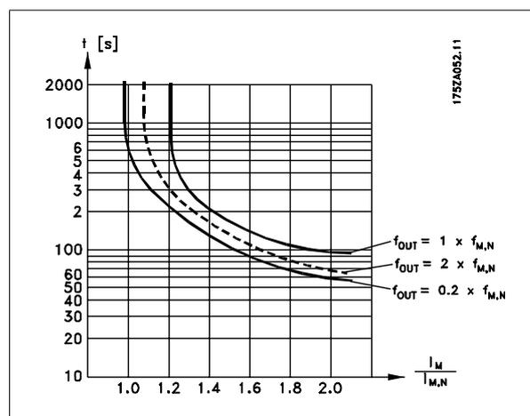
As funções ETR 1-4 correspondem ao Setup 1-4. As funções ETR 1-4 não começam a calcular a carga até você alternar para o Setup em que foram selecionados. Isto significa que é possível utilizar a função ETR inclusive ao alternar entre dois ou mais motores.
