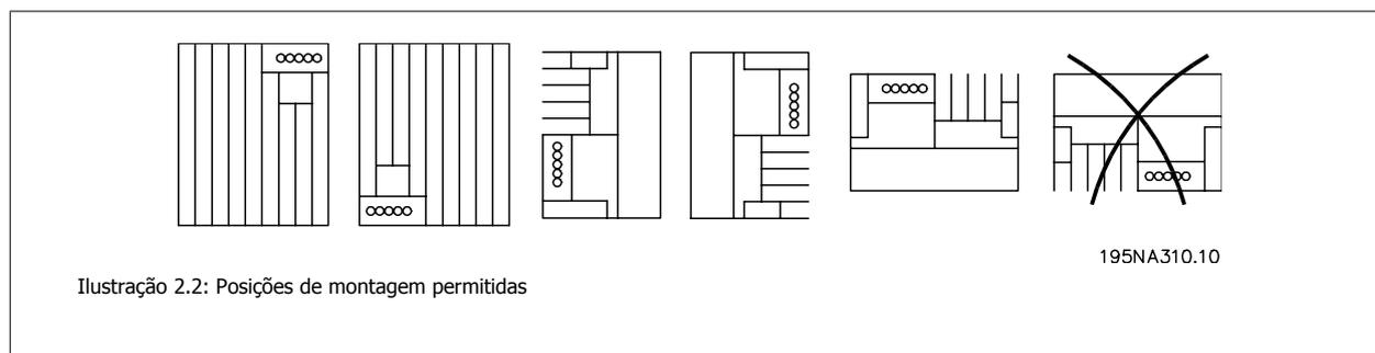
Ilustração 2.2: Posições de montagem permitidas
