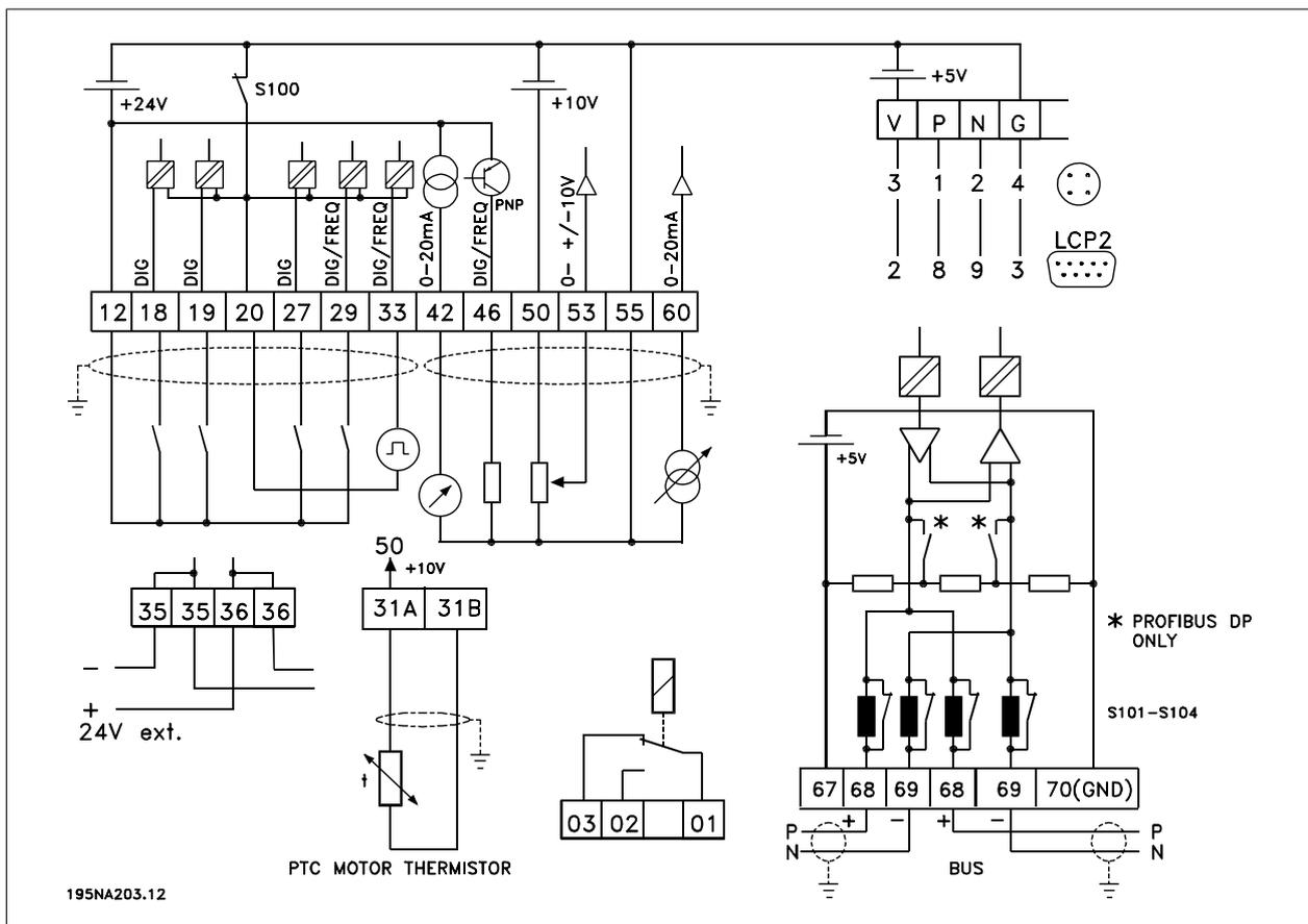
Interruptores S101-104 bobinas do bus serial, deixe os interruptores (ON) (Ligado)
