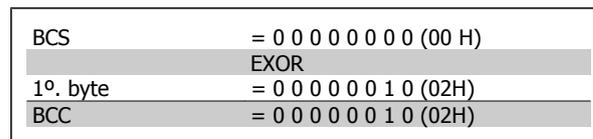
Cada byte subsequente é filtrado por BCS EXOR e produz um novo BCC, por exemplo.:
