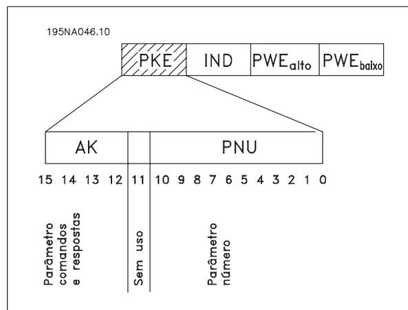
Os bits nos 12-15 são usados para transferir comandos de parâmetro do mestre ao escravo e as respostas processadas enviadas de volta do escravo ao mestre.
