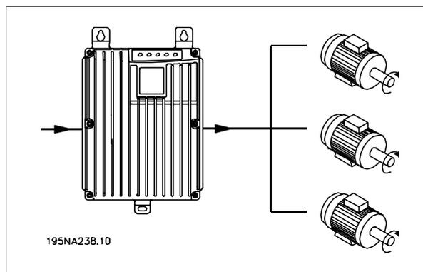
Se os tamanhos dos motores forem muito diferentes, poderão surgir problemas tanto na partida, quanto em baixas velocidades de rotação. Isto porque a resistência ôhmica relativamente alta no estator de motores pequenos necessita de uma tensão mais alta na partida, e em baixos valores de rotação.
