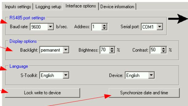
Fig. 3.4. Interface options tab functions
