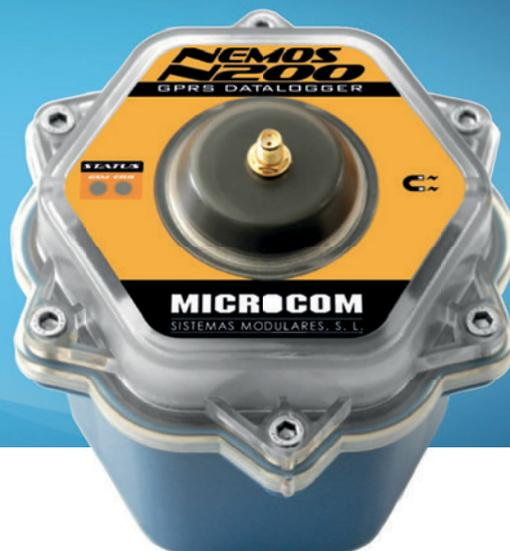
El NEMOS N200 es un dispositivo de adquisición de datos con comunicación GPRS y alimentación a pilas concebido para su operación en arquetas y entornos susceptibles de inundación (grado de protección IP68). Cuenta con cuatro entradas digitales aptas para caudalímetro de pulsos, y dos analógicas.
