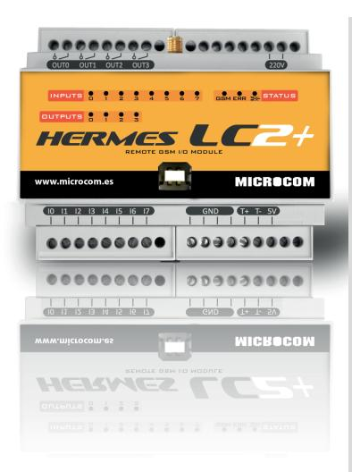
O Hermes LC2 + é um sistema de telecontrolo e telemetria baseado na tecnologia GSM / GPRS que dá suporte à monitorização de estações remotas de forma simples e eficiente. Possui 8 entradas digitais, 4 saídas a relé e capacidade de leitura de até 8 sondas de temperatura e humidade.
