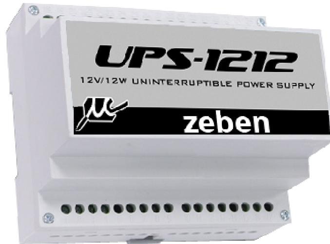
A UPS1212 apresenta-se numa robusta caixa para calha DIN incorporando os bornes para a ligação de rede, bateria, saída de 12v e sinal de falha de rede. Conta com uma saída de falha de rede com níveis TTL que pode ser utilizado junto com o sistema de telecontrolo Hermes para obter um sistema de alarme de falha de alimentação numa estação remota. A estabilidade da tensão obtém-se mediante reguladores comutados no secundário para a máxima eficácia e fiabilidade.
