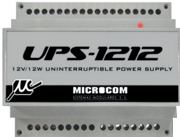
La UPS-1212 es una fuente de alimentación ininterrumpida de 12 voltios de corriente continua con gestión para carga de una batería de plomo de respaldo de 12 voltios y conmutación automática de esta en cuanto desaparece la tensión de red.
