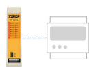
AUTÓMATOS E ANALISADORES DE REDES Permite a equipamentos externos com MODBUS RTU / RS485 serem monitorizados em tempo real
