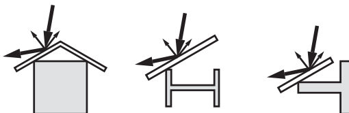
Fig. 15: Cobrir os perfis lisos com defletores
