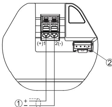
Fig. 19: Compartimento de conexões NivoRadar 7200
