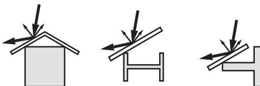
Fig. 15: Cobrir os perfis lisos com defletores
