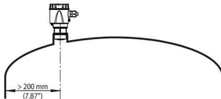
Fig. 10: Montagem do sensor de radar em teto de reservatório redondo
