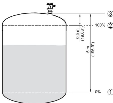
Fig. 23: Exemplo de parametrização Calibração Mín./Máx.
