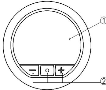
Fig. 20: Elementos da unidade de visualização e configuração integrada
