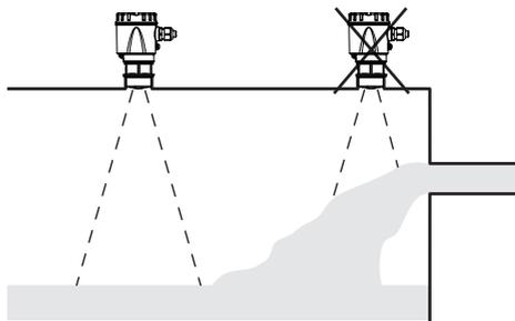
Fig. 12: Montagem do sensor de radar no fluxo de entrada do produto
