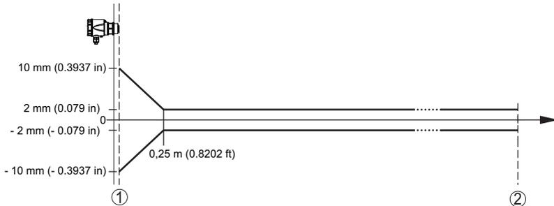
Fig. 6: Diferença de medição sob condições de referência <sup>2)</sup>
