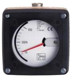
Este instrumento pode ser fornecido com conexão de compressão, conexão roscável fêmea e também com conexão p/ mangueira. A indicação da vazão é feita através do flutuador que transfere seu movimento de acordo com a vazão instantânea para o indicador por meio de um campo magnético.
