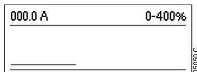
Si está conectado un teclado remoto, pulsar **ALT** para cambiar los datos del gráfico.
