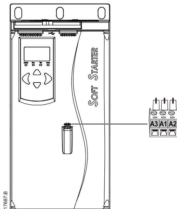
Conectar la alimentación de control según la tensión de alimentación utilizada.
