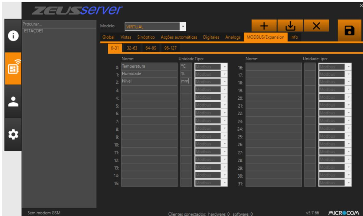
Ter em especial atenção os nomes dados aos canais ModBus/Expansion – o Plug-in vai apenas escrever em canais com nomes iguais aos *metrics* enviados por MQTT (independentemente do tópico), na estação do Zeus com nome igual ao DeviceID. Se o plug-in não encontrar uma estação com canal correspondente a um *metric*, este não será registado.
