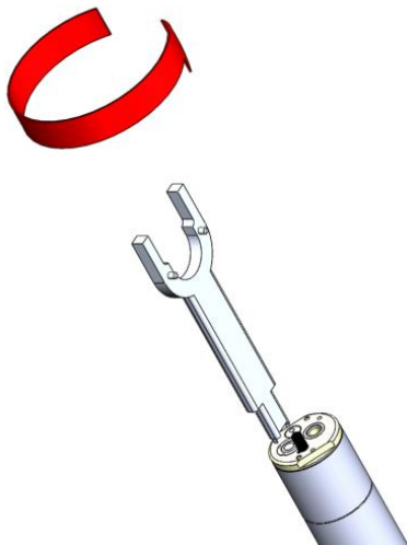
Figura 7: Desenrosque o sensor torcendo no sentido anti-horário.
