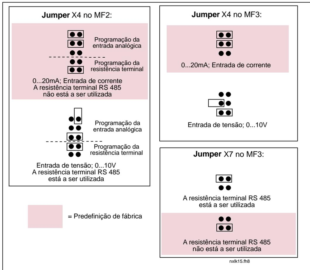
Figura 6-24. Seleccção do jumper para Vacon NXL, MF2 e MF3
