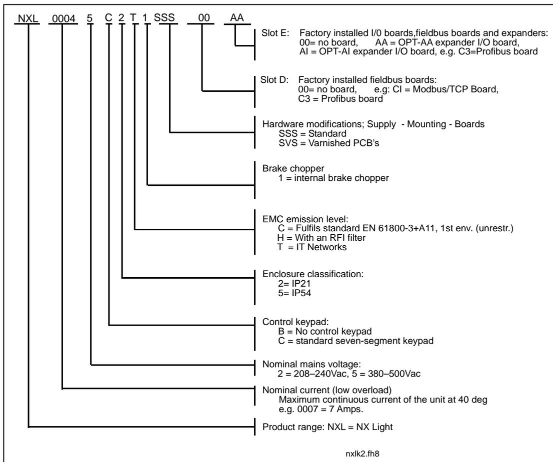
Figura 3-2. Código de designação do tipo Vacon NXL, MF4 – MF6,
