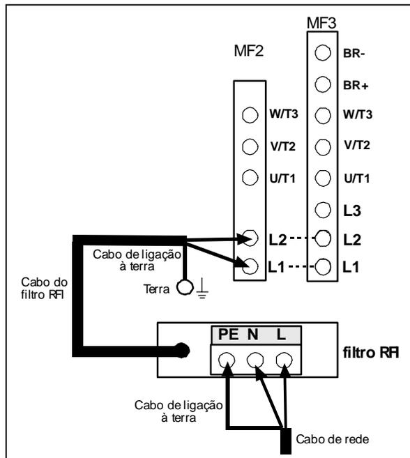
Figura 6-12. Instalação de um cabo RFI para MF2 e MF3, 208...240V, alimentação monofásica. Filtro tipo RFI-0013-2-1
