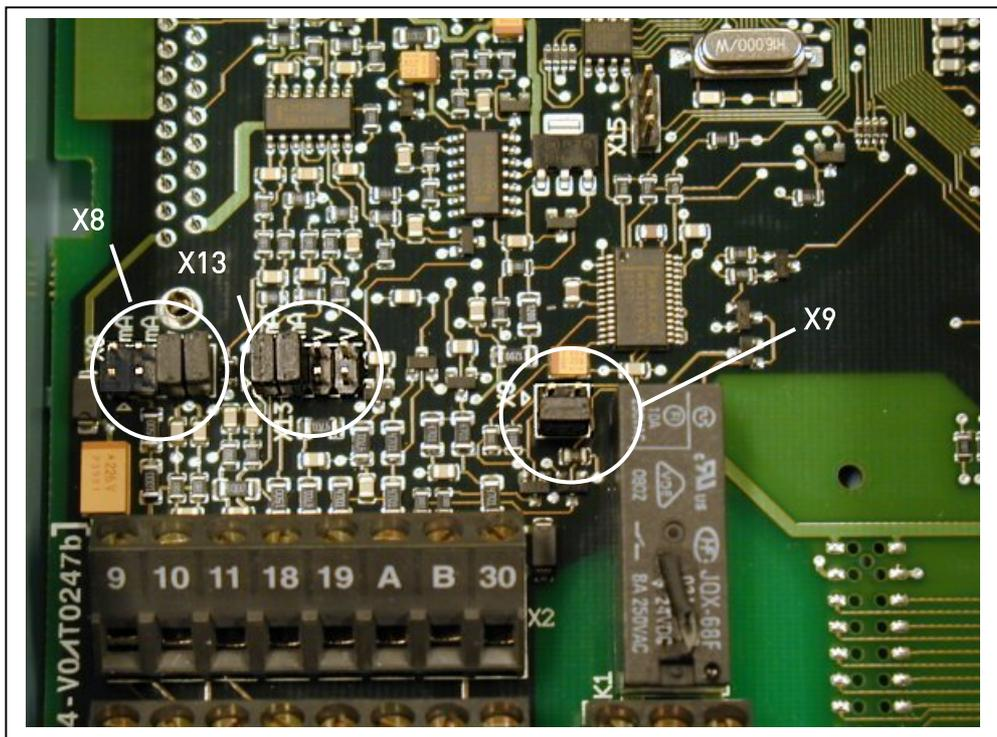
Figura 6-27. A localização dos jumpers no painel de controlo do MF4 – MF6
