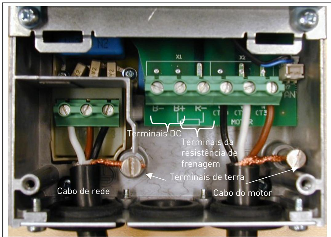
Figura 6-16. Instalação dos cabos no Vacon NXL, MF4
