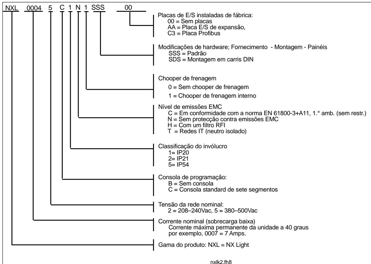
Figura 3-1. Código de designação do tipo Vacon NXL, MF2 e MF3.
