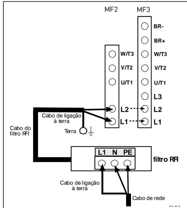
Figura 6-14. Instalação de um cabo RFI para MF2 e MF3, 208...240V, alimentação monofásica. Filtro tipo RFI-0012-2-1
