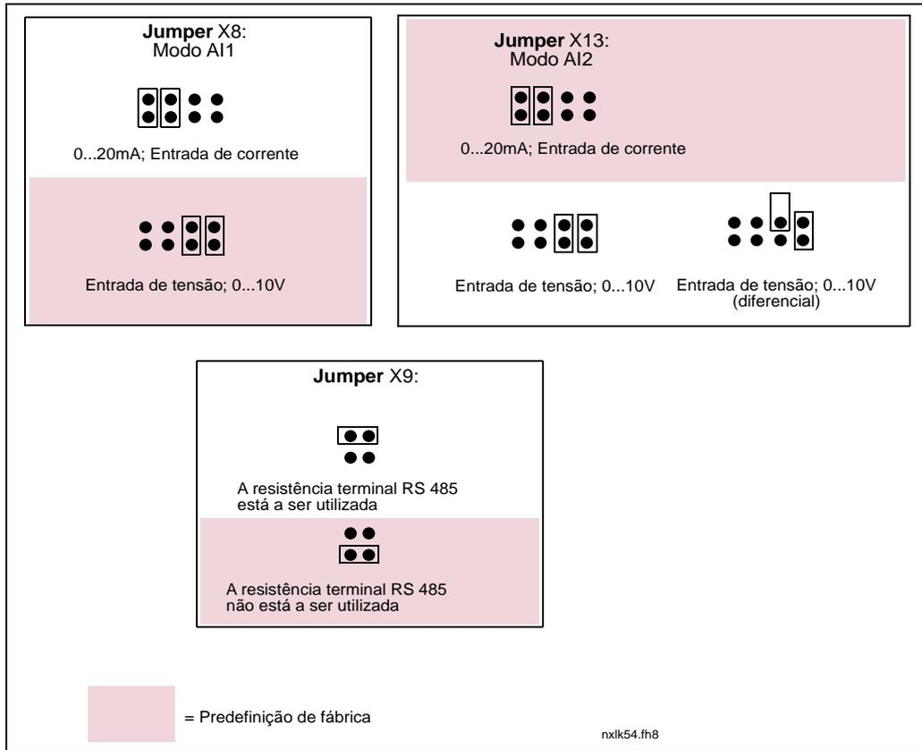
Figura 6-25. Selecção do jumper para Vacon NXL, MF4 – MF6
