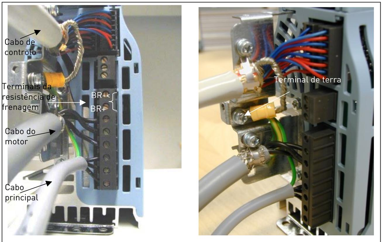
Figura 6-9. Instalação dos cabos no Vacon NXL, MF3
