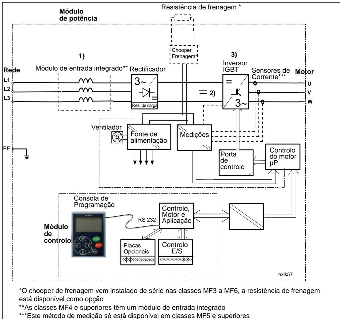
Figura 4-1. Diagrama de blocos Vacon NXL
