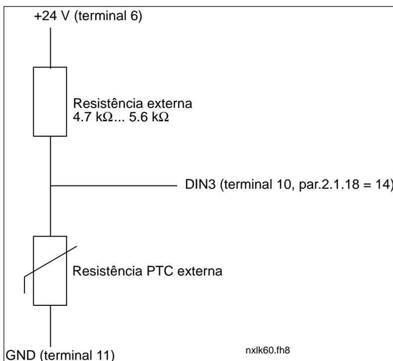
Figura 6-28. Ligação do termistor do motor (PTC)
