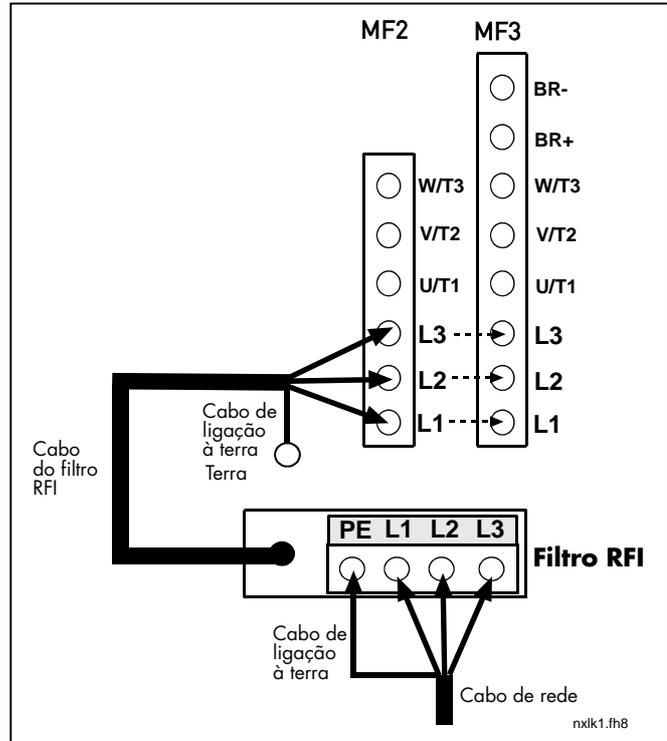
Figura 6-11. Instalação de um cabo RFI para MF2 e MF3, 380...500V, alimentação trifásica. Filtro tipo RFI-0008-5-1
