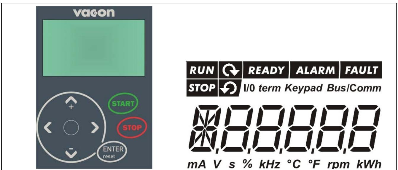
Figura 7-1. Teclado de controlo Vacon e indicações de estado do conversor
