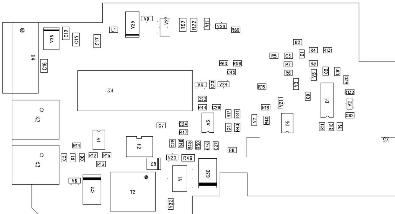
Descrição: placa de expansão de E/S com uma saída de relé (NO), três entradas digitais e uma entrada do termistor para conversores de frequência Vacon NXL.
