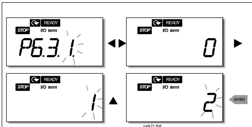
Figura 7-10. Armazenar e carregar conjuntos de parâmetros
