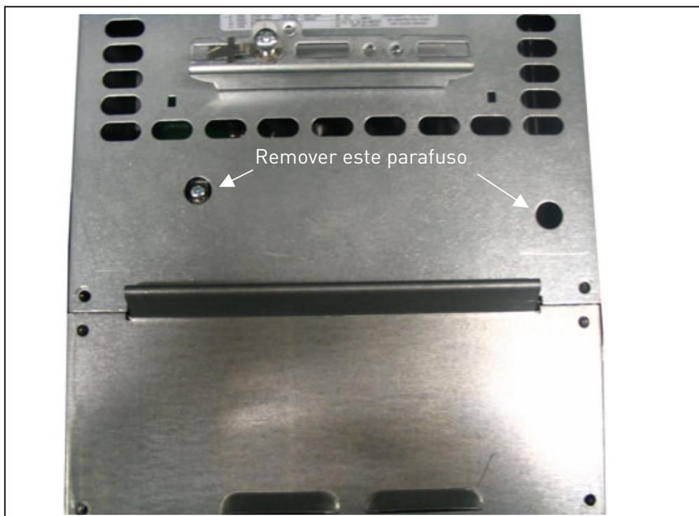
Figura 5-8. Modificação da classe de protecção CEM, MF6
