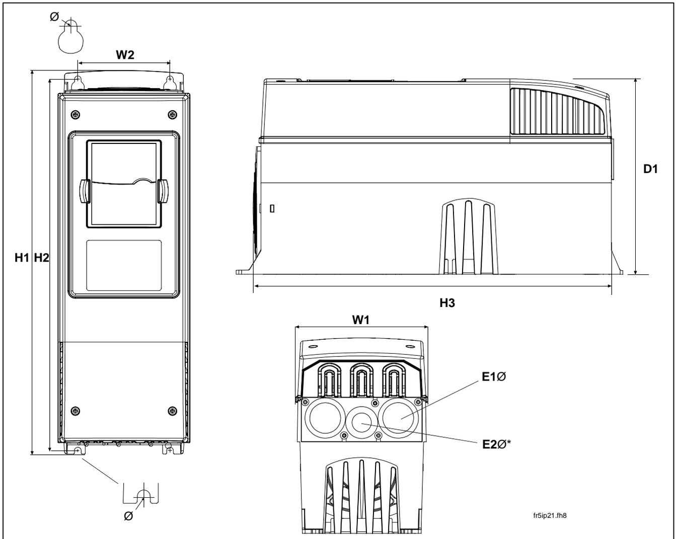
Figura 5-5. Dimensões do Vacon NXL, MF4– MF6
