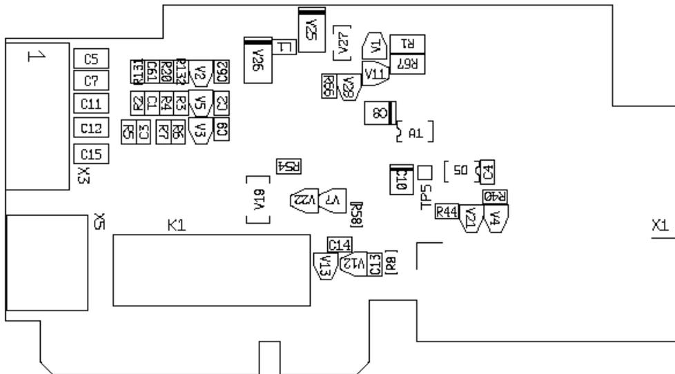
Descrição: Placa de expansão de E/S com uma saída de relé, uma saída de colector aberto e três entradas digitais.
