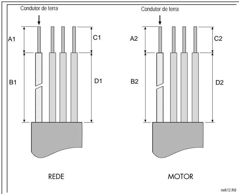
Figura 6-5. Desnudar os cabos
