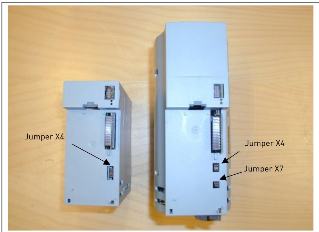
Figura 6-26. A localização dos jumpers no MF2 (esquerda) e MF3 (direita)
