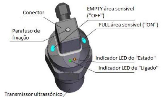
Fig. 29: Peças-chave do dispositivo de medição (versão com sondas Hall)
