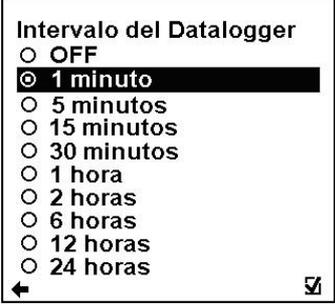
Aunque mientras que el caudalímetro muestra el error de “Tarjeta SD no insertada” o “No se puede abrir el archivo en la tarjeta SD” el usuario instale una tarjeta SD, el estatus de error no desaparecerá inmediatamente sino que se mantendrá hasta que se cumpla el intervalo fijado y el caudalímetro intente guardar los totalizadores en la tarjeta SD. Por eso se recomienda reconfigurar el intervalo del datalogger o reiniciar el caudalímetro cada vez que se inserte la tarjeta SD.
