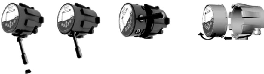
Una vez abierto el transmisor, introducir el cable de señal a través de la junta situada en la parte inferior de la caja del transmisor (ver apartado 2.1). Conectar el conector que esta al final del cable de señal a la placa base del transmisor.
