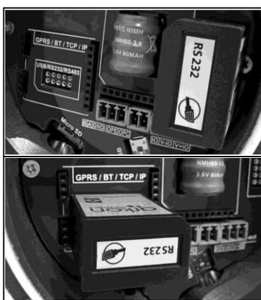
El módulo RS232 está colocado en una ranura diferente.
